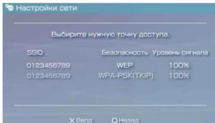
Идентификатор SSID - это код или имя, назначенное для точки доступа. Если идентификатор SSID неизвестен или не отображается, обратитесь к специалисту, который устанавливал или обслуживает данную точку доступа.
