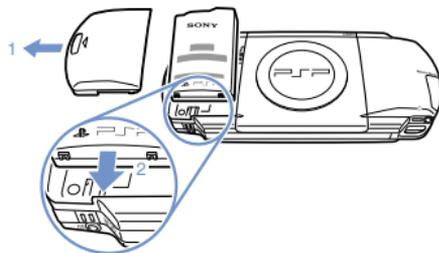
Совместите выступы, затем сдвиньте крышку батарейного отсека в направлении стрелки так, чтобы она плотно встала на свое место.
